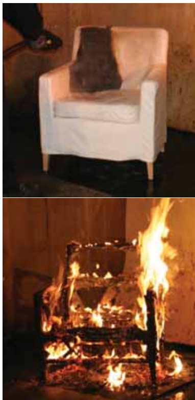
Bildene viser samme type lenestol utsatt for en mindre brannkilde. Den øverste stolen tilfredsstiller brannkravene i Storbritannia, den nederste dagens brannkrav i Norge. Foto: SINTEF NBL.
